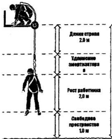
Запас высоты при использовании стропа с амортизатором рассчитывается с учетом суммарной длины стропа и соединительных элементов, длины сработавшего амортизатора, роста работника, а также свободного пространства, остающегося до нижележащей поверхности в состоянии равновесия работника после остановки падения.
